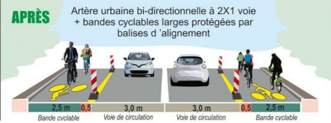
A 2X1 voie, en réduisant la largeur des voies :
